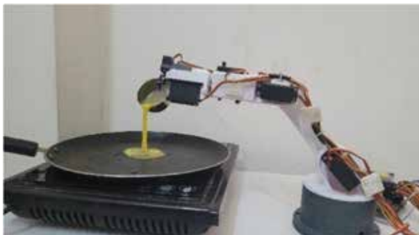
Fig 5 (d): Robo pouring the egg batter on the pan
